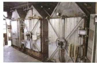
入荷されたプリント品はこの蒸し機の中、100℃の水蒸気でプリント品が蒸される
