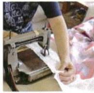
水洗工程の前に蒸された生地を縫合
